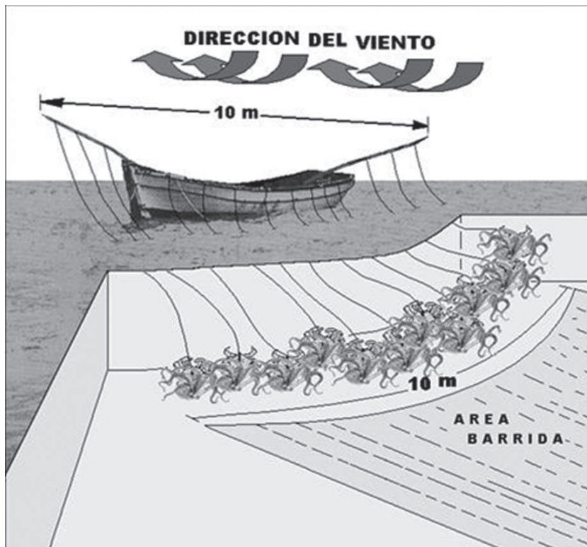
Figura 3. Método de pesca de pulpo en la Península de Yucatán conocido como “gareteo” (tomado de Hernández et al. 2000) y definición del área barrida.
